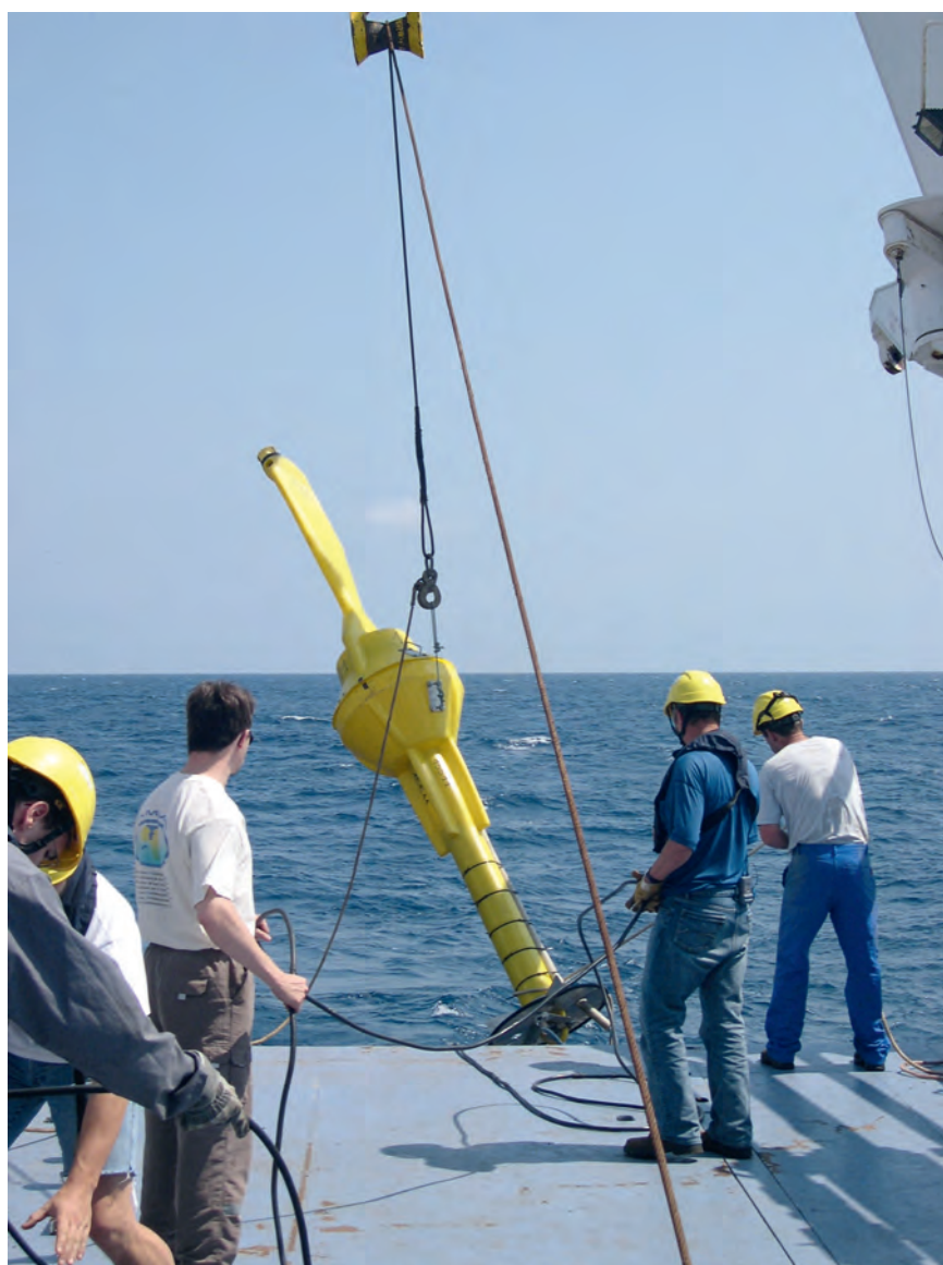
Mise à l'eau d'une bouée dérivante Marisonde à bord du N/O L'Atalante lors de la campagne EGEE-3
